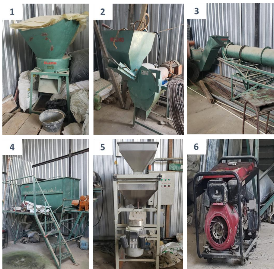
Ilustración 3. La asociación cuenta con 1. Ralladora de yuca, 2. Molino martillo, 3. Secadora, 4. Mezcladora, 5. Peladora de sachu inchi y 6. Planta eléctrica.
